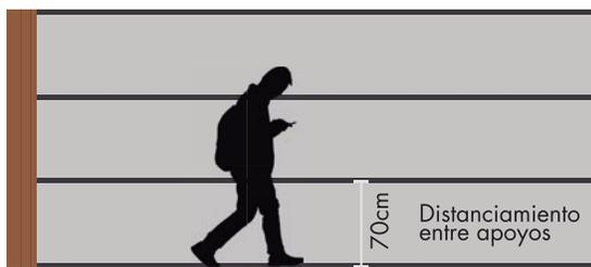
Alinee y nivele su Wallpanel liso con la estructura portante previamente instalada, iniciando por su ranurado o línea de fijación, Para quiebres, deje volada la esquina del Wallpanel 1cm, esto servirá para recibir la pieza de quiebre.
