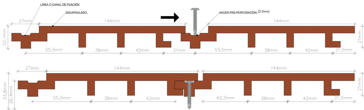
Si es necesario Instale la estructura portante disponiendo de durmientes cada 70cm, perpendicular a disposición de su Wallpanel liso, ya sea vertical u horizontal.
