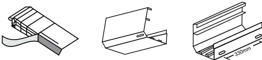
Instale las láminas **Arkowall** con la cara identificada que tiene la protección UV hacia el exterior o identifique la cara que no tiene las ranuras para el enganche de las platinas. **Fig. 1** El sistema se integra enganchando las láminas dotadas de elementos "macho/hembra" para el perfecto acoplamiento, completando la estructura de fijación con marcos perimetrales en aluminio.
