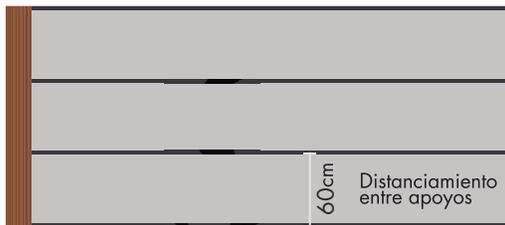
Para aplicarlo en cielo falsos o muros alinee y nivele su Wallpanel liso con la estructura portante previamente instalada, iniciando por su ranurado o línea de fijación, Para quiebres, deje volada la esquina del Wallpanel 1cm, esto servirá para recibir la pieza de quiebre.
