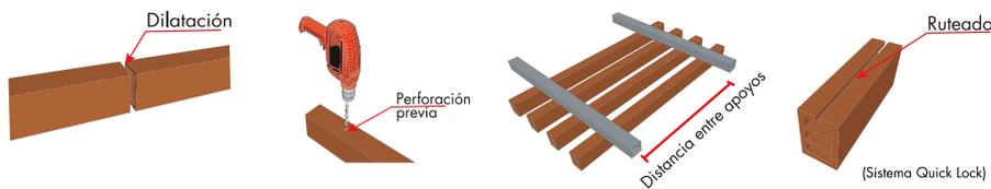
\* El Arkowood H es un producto fabricado en WPC: 50% madera, 40%HPDE y 10% aditivos. El Arkowood H es un producto fabricado mediante un proceso de co-extrusión con altas temperaturas; razón por la cual, es normal que se presenten irregularidades en su geometría de (mm) entre las diferentes piezas; esto en ningún caso afecta la calidad intrínseca del producto.
