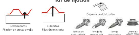
Al inicio, al final y en los traslapos de cada teja, las fijaciones a las correas deben ser colocadas en cada una de las crestas. En las correas intermedias, las fijaciones deben ser colocadas como se indica a continuación:
