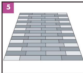
5 Instale laminas de varias cajas con el fin de mitigar el acabado o tono.
