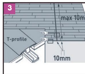
3 Si el área a instalar supera los 10 m<sup>2</sup> implemente una junta de dilatación por medio de pirlan o similar.
