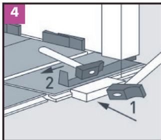
4 Para hacer ajustes o acoplamiento entre laminas use maso de caucho
